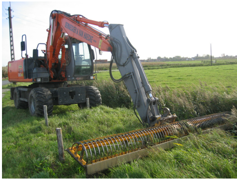
Foto 11. De korfmaaiër is een goede vervanger van het traditionele handmaaien. Deze methode beperkt de negatieve impact op onder meer amfibieën (Bron: Econnection)
