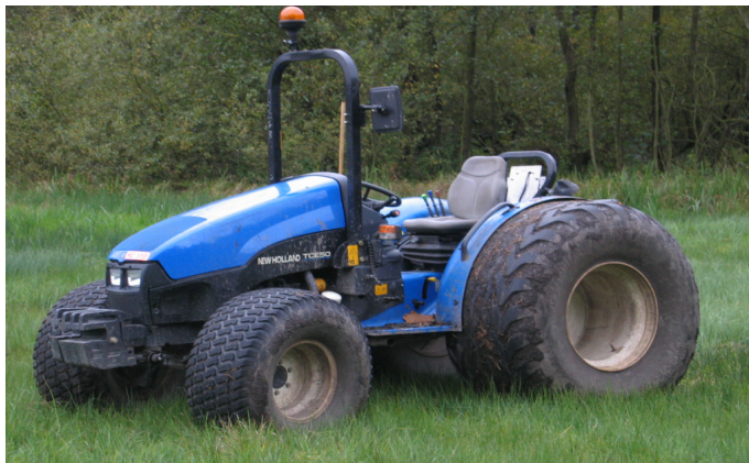
Foto 13. De moerastractor wordt ingezet in drassige terreinen. Deze tractor biedt het voordeel van minimale bodemverdichting en -beschadiging (Bron. Econnection)
