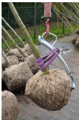
Figuur 1: Verplaatsen boom met rondstrop en kluithaak - ©damcon nl
