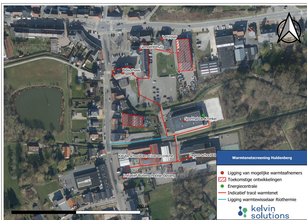
Figuur 4.2: Ligging warmtewisselaar in transportleiding van Aquafin ter hoogte van geselecteerde cluster in Huldernberg
