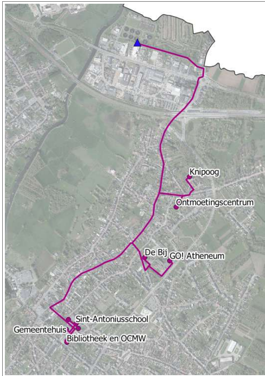
Figuur 24: Traject van een warmtenet, gevoed vanuit de afvalwaterzuiveringsinstallatie van Aquafin, volgens scenario 1 in het centrum van Liedekerke
